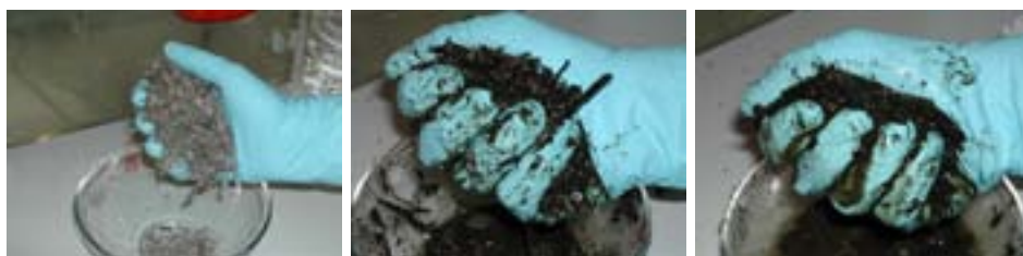
Figura 4.12: Test del puño. De izquierda a derecha: material seco; material con la humedad adecuada; material demasiado húmedo.
