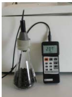
Figura 4.9: Tapón con sonda de oxígeno incorporada para poder realizar medidas de oxígeno dentro del matraz
