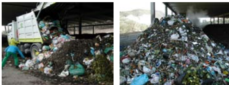
Figura 6.1: Recepción de FORM y vista general de una pila de FORM acabada de montar
