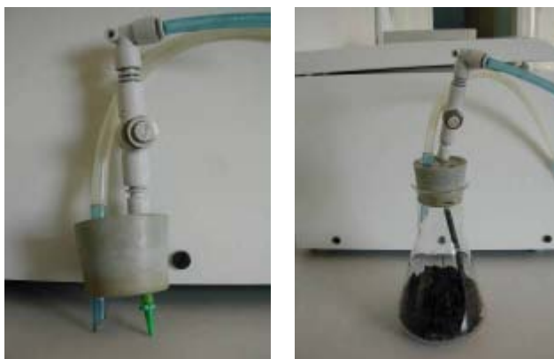
Figura 5.4: Tapón de incubación donde se observa el regulador de caudal de aireación a la entrada del tapón y la conexión para ajustar el tapón de incubación a la red-soporte
