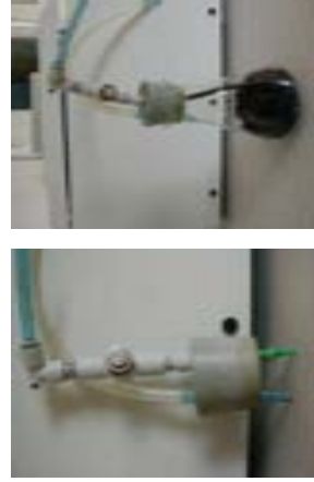
Figura 2.3: Tapón de incubación. Se observa la válvula que regula el caudal de aireación a la entrada del tapón y la conexión para ajustar el tapón de incubación a la red-soporte.
