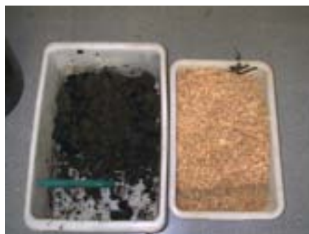
Figura 5.2: Materiales utilizados: en la cubeta de la izquierda lodo digerido centrifugado y en la de la derecha virutas de madera utilizadas como agente estructurante
