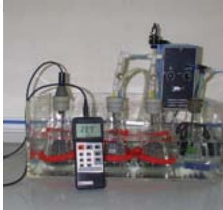
Figura 4.6: Imagen del respirométo donde se muestra el oxímetro dentro de un matraz adquiriendo datos y dos muestras incubando
