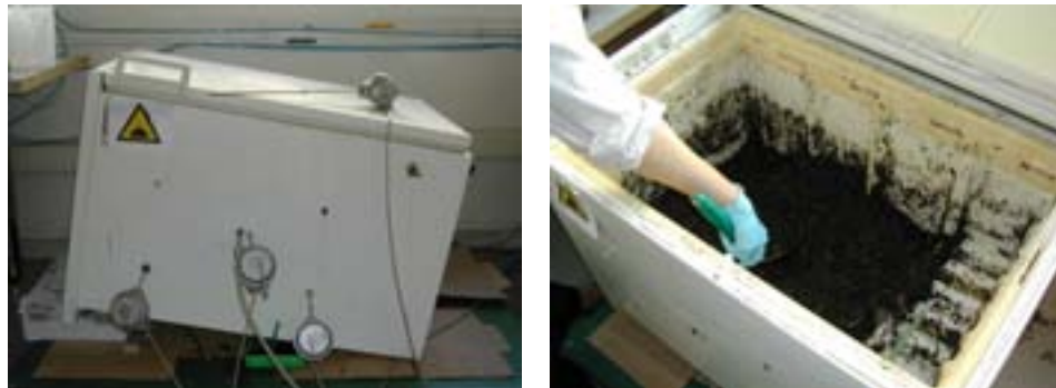
Figura 4.3: Reactor estático de 100 L procesando lodos de depuradora.
